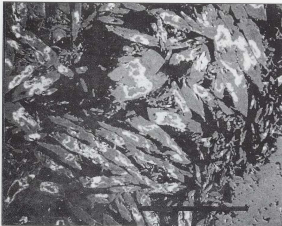
Figura 4.- Fotomicrografía de una sección pulida vista en el MEB (electrones secundarios) en la que se ven cristales tabulares de alunita tipo 1 (gris claro) acompañados de cuarzo (ángulo inferior izquierdo) y de una matriz criptocristalina de caolinita y pirofilita (negro). Los cristales de alunita contienen núcleos de woodhousita-svanbergita (blanco) parcialmente disueltos. La escala mide 150 \mu\text{m} .
